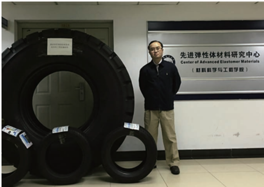
图 1 橡胶/CNT 纳米复合材料在高性能轮胎中的应用 (包含橡胶/CNT 纳米复合材料零件的节能轮胎和工程轮胎的产品，工程轮胎的轮辋直径和横向宽度分别为 33 英寸和 18 英寸，其外径超过 1.9 m)
