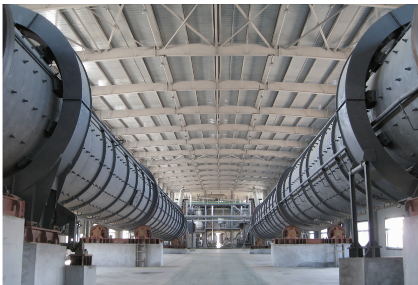
位于示范工厂的长约55米发酵罐是世界上最大的成功运转的固体发酵装置
