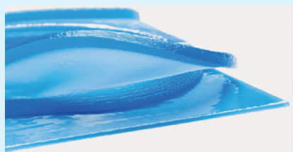
图 2 利用瓦克新开发的 3D 打印技术打印而成的硅橡胶密封唇
