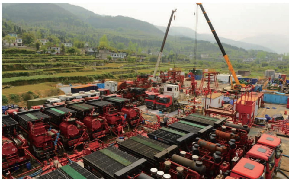
在国内首个大型页岩气田——涪陵页岩气田，中石化江汉石油工程运用自主研发的 3000 型压裂车在焦页 9 号平台进行国内首次“井工厂”模式压裂试气（胡庆明 摄）
