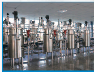
燃料乙醇试验装置
