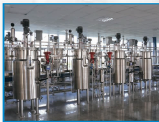
燃料乙醇试验装置
