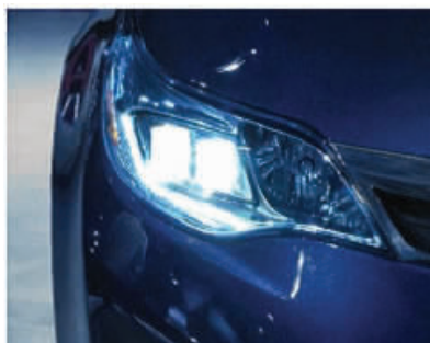
汽车前灯聚光透镜与反射灯罩
