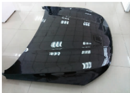
图 1 华晨汽车碳纤维复合材料的发动机罩盖
