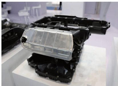
Durethan® BKV30H2.0 在发动机油底壳上的应用
