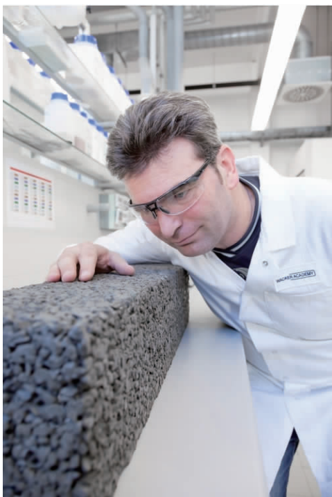
图为聚合物改性透水混凝土正在进行实验室测试
