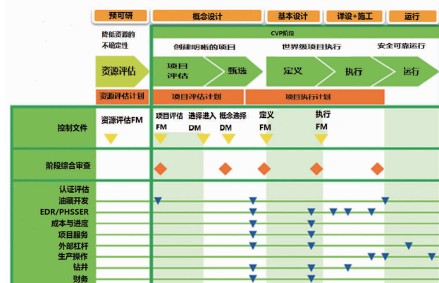
图2 CVP工作流程和强制要求
