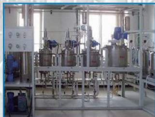
丁苯橡胶模试装置
