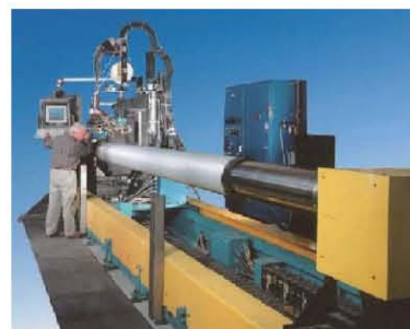
分管段的缠绕成型工艺
