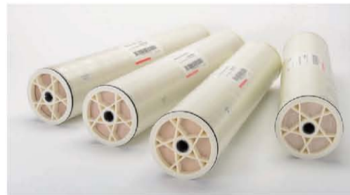
朗盛 Lewabrane 系列膜分离元件由聚酰胺薄膜组成，多层卷绕形成螺旋状元件
