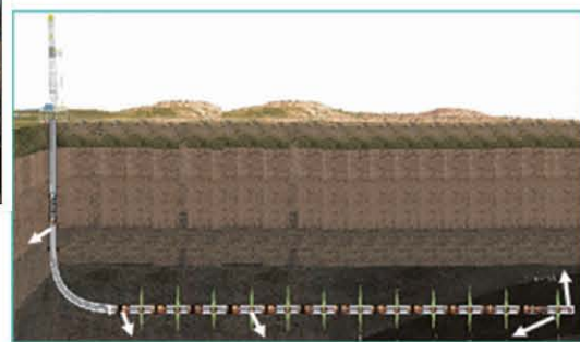
图8 水平井分段压裂
