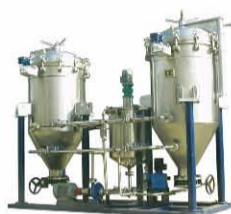
密闭加压叶滤机 过滤面积: 1 ~ 100 m²
