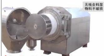
新一代 翻袋式自动离心机 转鼓直径: 300 ~ 1000 mm
