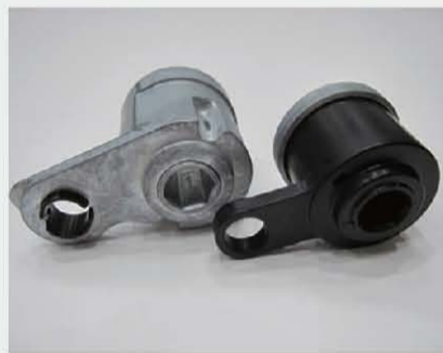
塑料座椅阻尼器 vs. 传统座椅阻尼器
