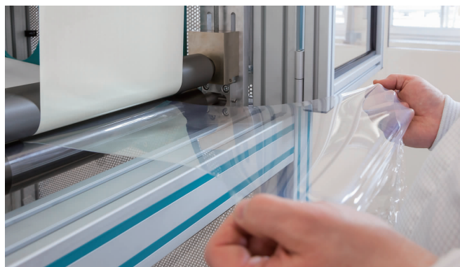
研发人员正在实验室抽取有机硅薄膜样品
