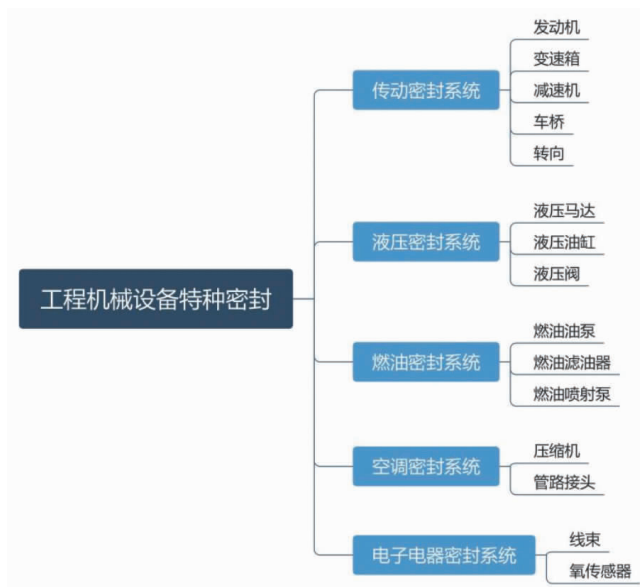
图2 特种密封弹性体在工程机械设备上的应用
