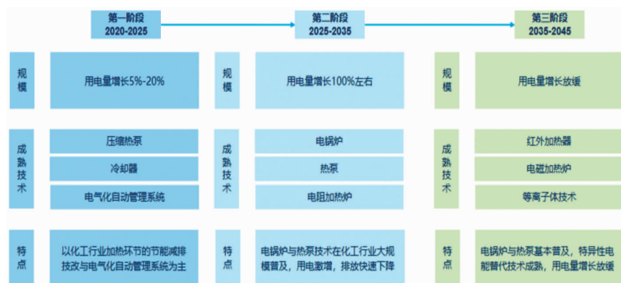
图3 化工行业加热环节电能替代技术发展路径
